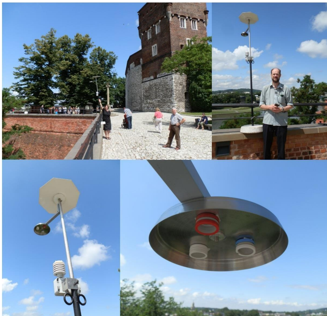
Rys. 4: Próbnik montowany w punktach na zewnątrz obiektu. Na fotografiach przedstawione zostały próbniki pasywne typu IVL (niewielkie okrągłe próbniki znajdujące się pod okrągłym talerzem oraz rejestrator poziomów RH i T marki Hanwell, montowany na środkowej części słupa.
